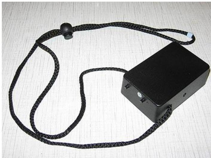
Прибор питается от встроенного аккумулятора и при средних реальных потребностях пользователя позволяет обходиться без подзарядки более 1 месяца. В момент включения прибор оповещает о приблизительном уровне зарядки аккумулятора. В случае предельного разряда аккумулятора во время пользования прибор выдает предупредительный сигнал и отключается.
