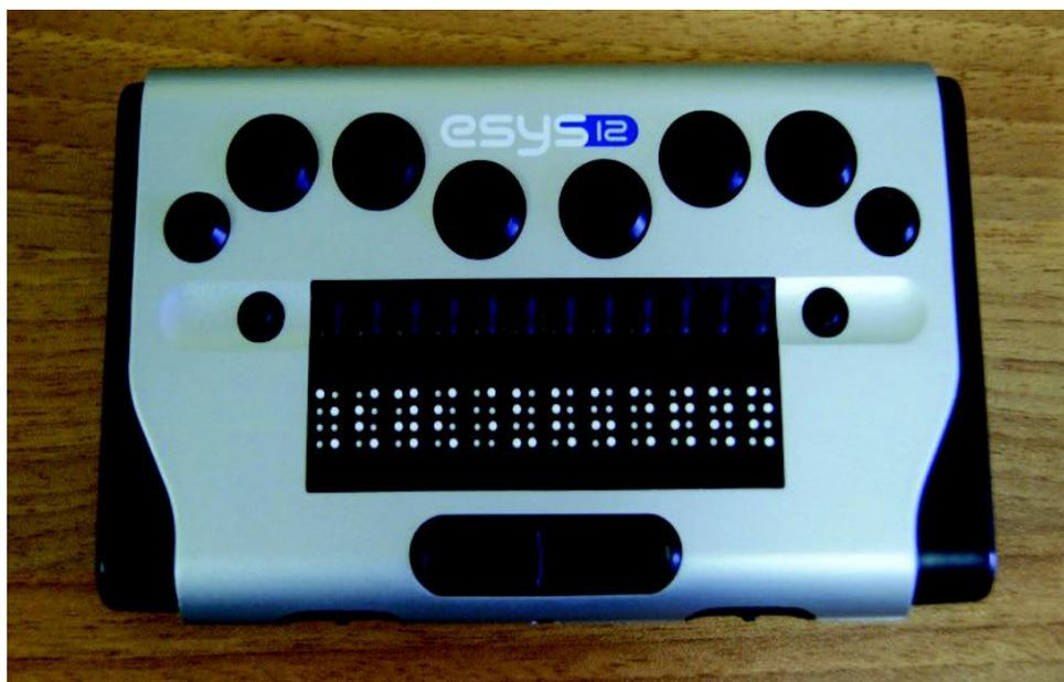
Благодаря Bluetooth технологии и специальному программному обеспечению, брайлевский дисплей Esys 12 может быть подключен к мобильному телефону или к персональному компьютеру. 10 клавиш клавиатуры Брайля дает возможность воспроизводить все стандартные комбинации клавиш, как для набора текста, так и
