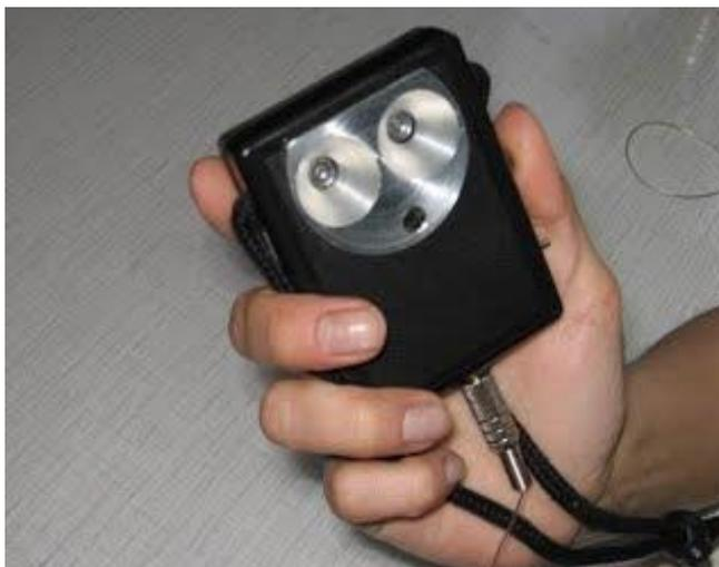
У модели **«Сонар-5УФ-В4»** вибрационные сигналы формируются на миниатюрном внешнем вибродатчике. Он закрепляется в любом удобном месте на одежде, ближе к телу, при помощи прищепки. Данный вариант предпочтительнее, если фонарик размещается на груди, т.к. позволяет надежно воспринимать вибрации независимо от толстой одежды. Звуковые сигналы поставляются пользователю через любой стандартный головной телефон, если он подключен к выходному разъему прибора.
